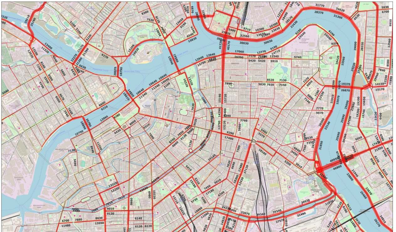
Рисунок 5.28 – Картограмма распределения среднегодовой суточной интенсивности движения транспорта для варианта 3
